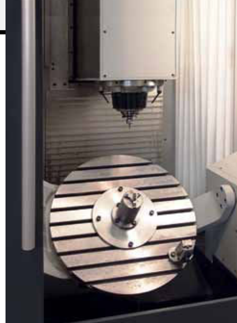
La tavola rotobasculante consente lavorazioni di grande precisione su stampi da creare in una unica presa pezzo
