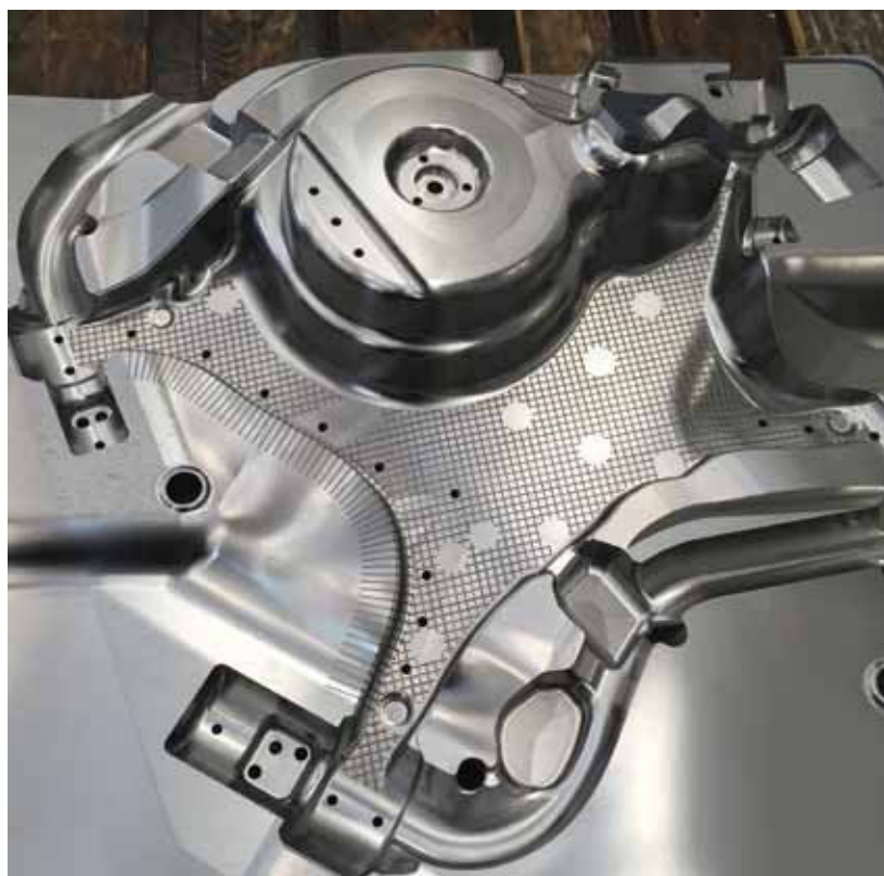
Particolare di uno stampo ad alta tecnologia destinato al settore automotive realizzato con Leonard Big in 5 assi in continuo
