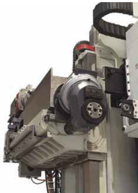
Alla corsa dell'asse Z trasversale si somma un modulo RAM (asse W) della testa operatrice con sezione di 420x420 mm
