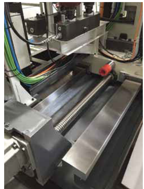
La macchina effettua inversioni precise e ripetibili grazie anche a guide lineari a strisciamento rivestite con turcite che agiscono su piani temprati e rettificati
