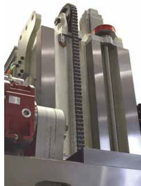
L'asse Y è dotato di tre guide piane disposte sul fianco del montante mobile
