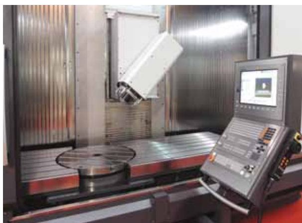
Newton Big T5 offre grande flessibilità operativa grazie a configurazioni a 3, 4, 5 o più assi e alla possibile suddivisione in due zone di lavoro
