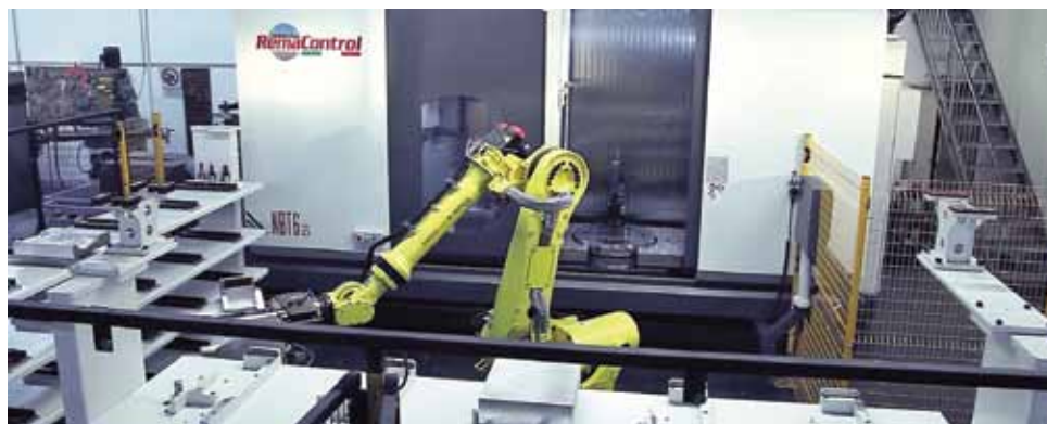
Il centro di lavoro può essere configurato a doppia zona per cicli in pendolare e a isola robotizzata
