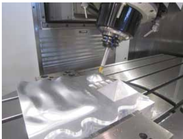
Newton Big T5 può realizzare pezzi di alta complessità con lavorazioni "dal grezzo al finito" in un unico piazzamento
