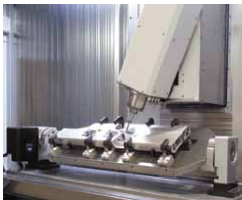
La testa operatrice orientabile in continuo da CN permette di eseguire geometrie con profili particolareggiati sui materiali più diversi
