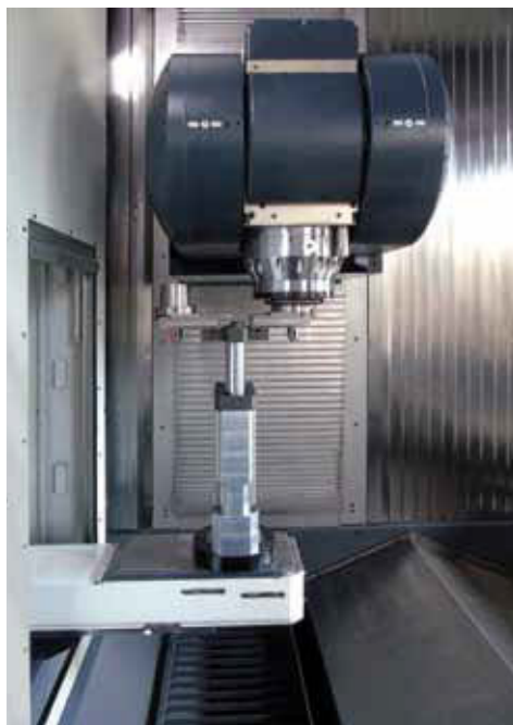
A sinistra: la preparazione al cambio utensile avviene in tempo mascherato e il cambio stesso richiede pochi secondi
