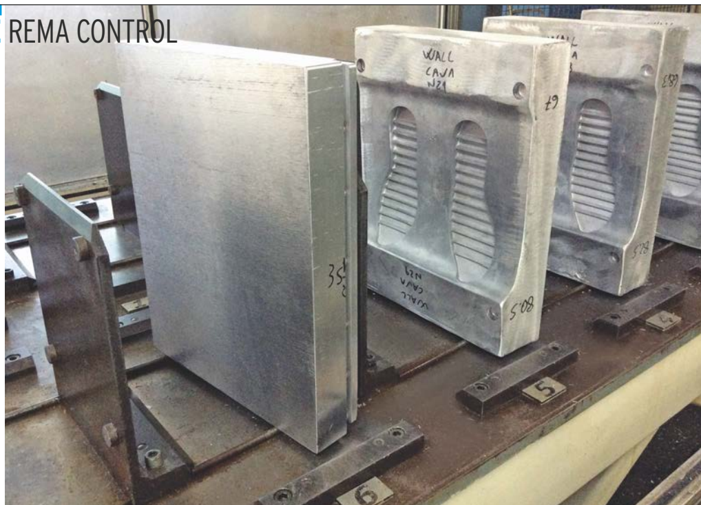
Gli stampi grezzi sono costituiti da blocchi di alluminio generati per fusione e che, spesso, presentano già l'impronta della suola da finire
