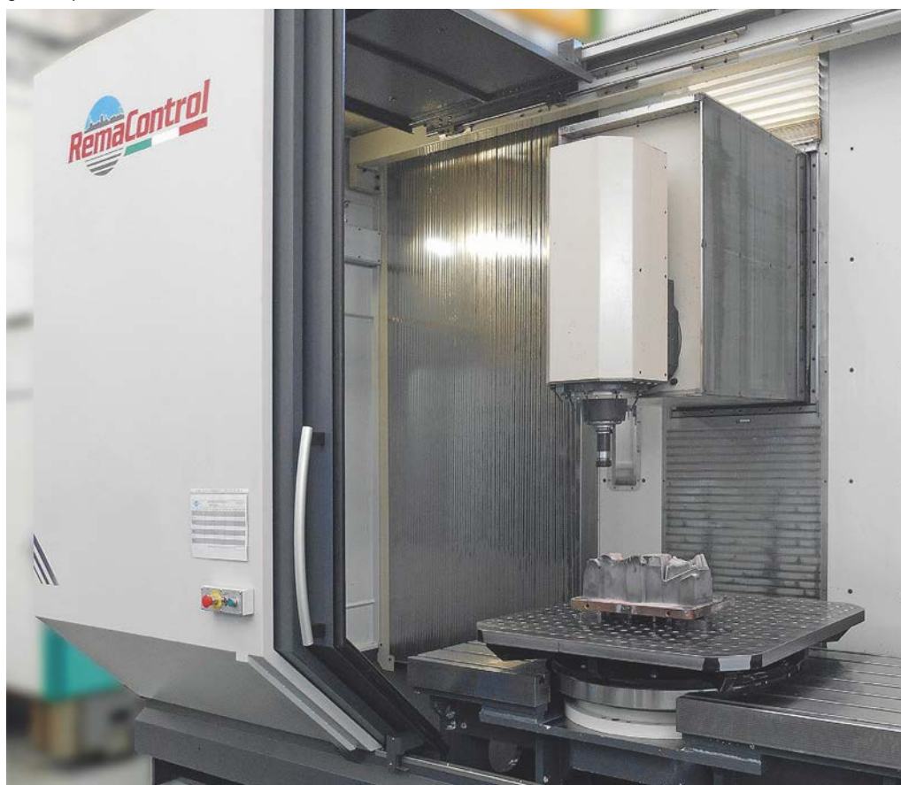
Gli stampi grezzi sono costituiti da blocchi di alluminio generati per fusione e che, spesso, presentano già l'impronta della suola da finire
